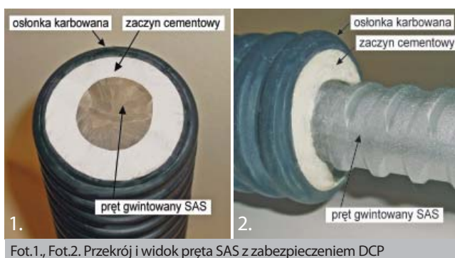
Fot. 1., Fot. 2. Przekrój i widok pręta SAS z zabezpieczeniem DCP
